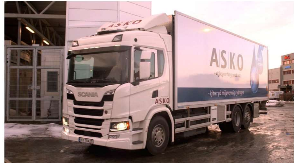
De fire lastebilene som settes i drift har en rekkevidde på 500 kilometer med totalvekt 26 tonn. Lastebilene er produsert av Scania med støtte fra blant annet ENOVA.
