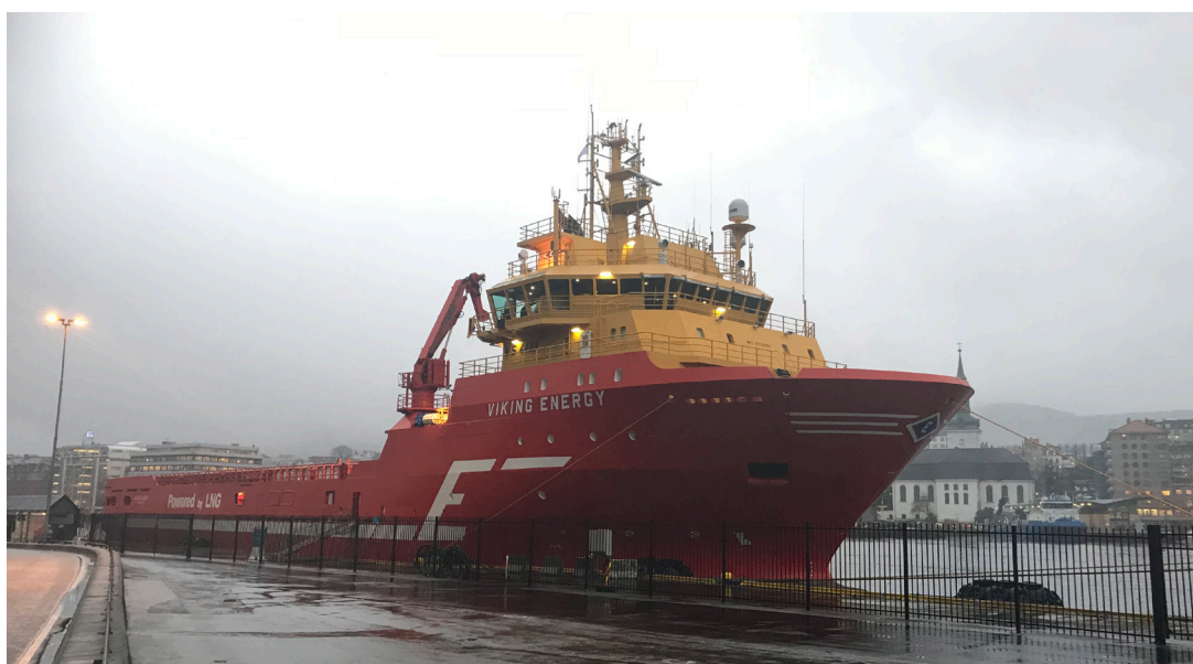
Supplyskipet Viking Energy skal bygges om fra LNG-drift til ammoniakk-drift. Foto: Kirsten Å. Øystese
