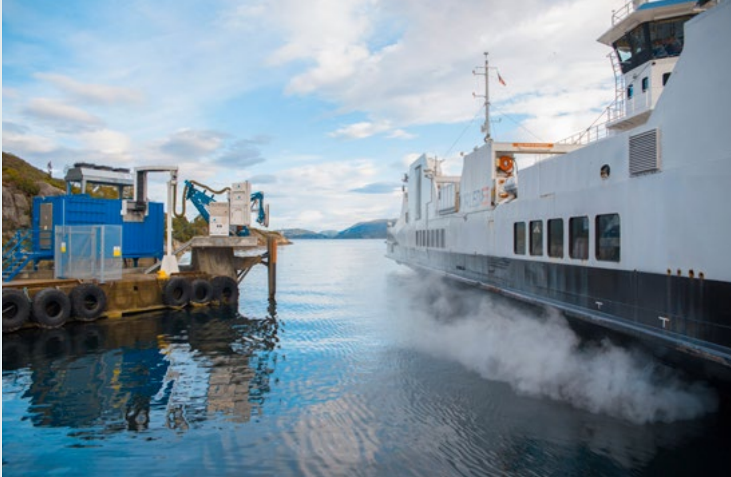
PÅ M/F FOLGEFONN - SOM TRAFIKKERER JEKTAVIK-NORDHUGLO-HODNANES I HORDALAND - PRØVES UT SYSTEMET MED TRÅDLØS LADING. (FOTO: WÄRTSILÄ)
